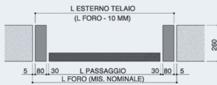
POSIZIONE IN LUCE STRUTTURA SPAZIO HF
