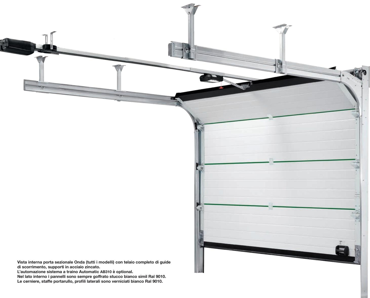
Vista interna porta sezionale Onda (tutti i modelli) con telaio completo di guide di scorrimento, supporti in acciaio zincato. L'automazione sistema a traino Automatic AB310 è optional. Nel lato interno i pannelli sono sempre gofrato stucco bianco simil Ral 9010. Le cerniere, staffe portarullo, profili laterali sono verniciati bianco Ral 9010.
